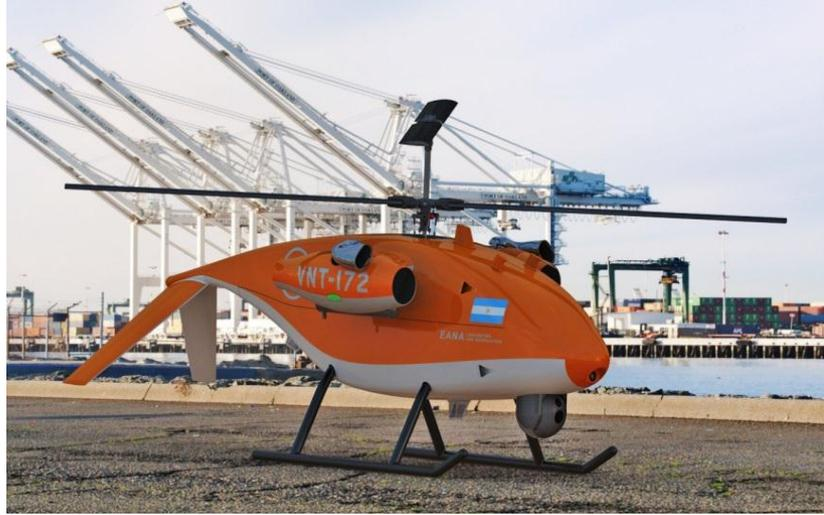
En el marco de esta novedosa herramienta, para actividades de Defensa y Seguridad, INVAP ofrece instrumentarlo con la Plataforma giroestabilizada con Sensores EO/IR, LIDAR y radar SAR en banda X, para así brindar la capacidad de detectar, reconocer e identificar objetos móviles y estacionarios tanto en tierra como en el mar.
